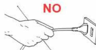
Quando una spina si rompe occorre farla sostituire con una nuova marchiata IMQ (Istituto italiano del Marchio di Qualità). Non tentare di ripararla con nastro isolante o con l'adesivo. E' un rischio inutile! Non attaccare più di un apparecchio elettrico a una sola presa. In questo modo si evita che la presa si surriscaldi con pericolo di corto circuito e incendio.
